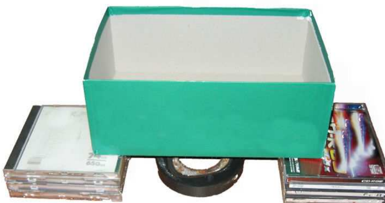
Fig. 13: disposizione della scatola di cartone, della base magnetica e della pila di distanziali (custodie di CD/DVD). I singoli distanziali, in seguito, possono essere tolti o aggiunti per trovare l'altezza idonea.
