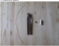
Man braucht 45 cm Kupferkabel, keine Litze sondern steifes Kupferkabel wie für normale Wohnungselektrik. Weiterhin eine Kneifzange zum Ablängen und evt. zum Abisolieren der Kupferdrähte, einen Accu (empfohlen: 2000 mAh) und einen Powermagneten, z.B.: Scheibenmagnet D=15mm, H=8mm (Bestellnr.: S-15-08-N bei www.supermagnete.de)
